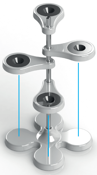
Korrekte Position der Trichterhalter
