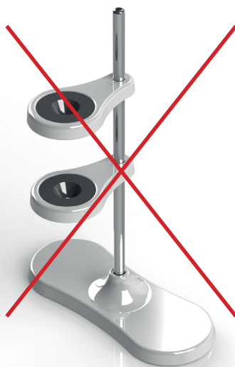
Неправильное положение держателей воронок - опасность опрокидывания!
