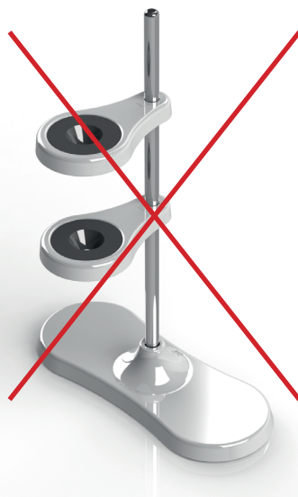
Falsche Position der Trichterhalter - Kippgefahr!
