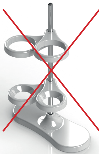
Неправильное положение держателей воронок - опасность опрокидывания!
