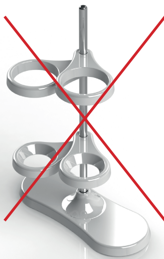
Неправильное положение держателей воронок - опасность опрокидывания!
