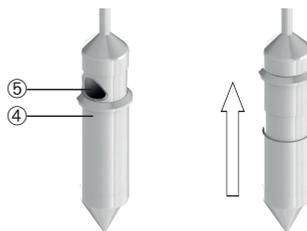
2. A la profundidad deseada, retire el instrumento aproximadamente 10 cm. De esta forma, la funda abre automáticamente la cámara colectora.
