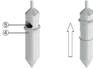
2. In gewünschter Tiefe das Gerät ca. 10 cm zurückziehen. Hierdurch öffnet die Verschlusshülse die Einfüllöffnung.
